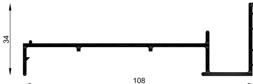
MT-1148 Guía cortina regulable Peso estimado: 0.737 Kg/m Largo STD: 6030 mm
