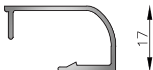
MT-6535 Contravidrio recto interior 15mm Peso estimado: 0.166 Kg/m Largo STD: 6030 mm
