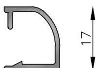
MT-0232 Contravidrio curvo interior 22mm Peso estimado: 0.181 Kg/m Largo STD: 6030 mm
