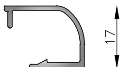
MT-0230 Contravidrio curvo interior 29mm Peso estimado: 0.213 Kg/m Largo STD: 6030 mm
